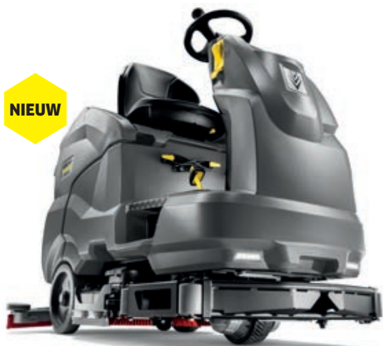
Zitschrobmachine B 220 R ■ Max. rijsnelheid: 10 km/u
